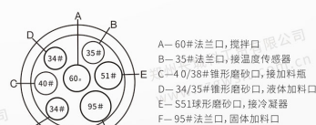
80~100L反应釜釜盖布置示意图
